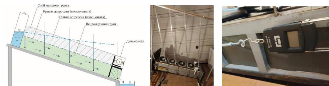
Рис. 3. Схема и фотоустановки для определения давления на подпорную стенку слоя мерзлого грунта с пригрузом, сползающего по границе с талым грунтом.
