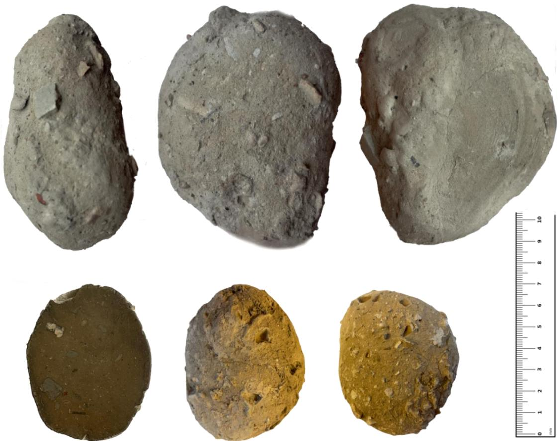
Рис. 2. Панцирные глиняные шары из ленточных глин карьера «Эталон»: уплощенная форма (в трех проекциях); вытянутая – поперечный разрез и вид с торца.
