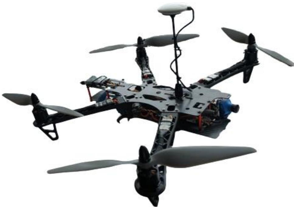
Рис. 2. Опытный образец беспилотного летательного аппарата, изготовленного по трехмерной модели.
