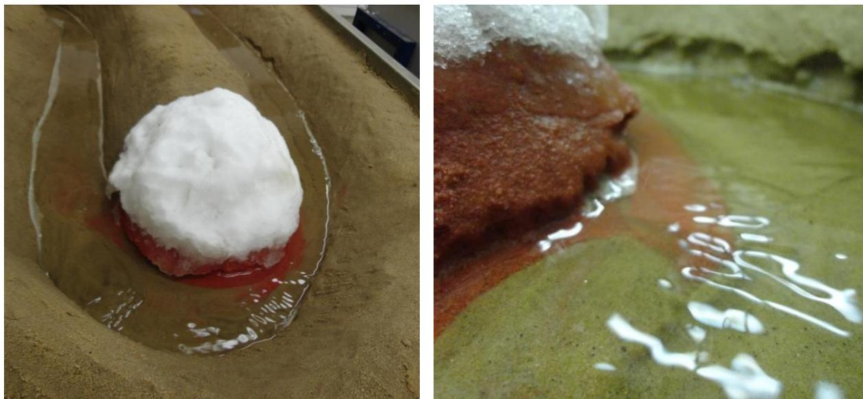
Рис. 1. Лабораторный эксперимент. Слева - начало размыва внешнего склона; справа – вид излучины после проведения эксперимента.
