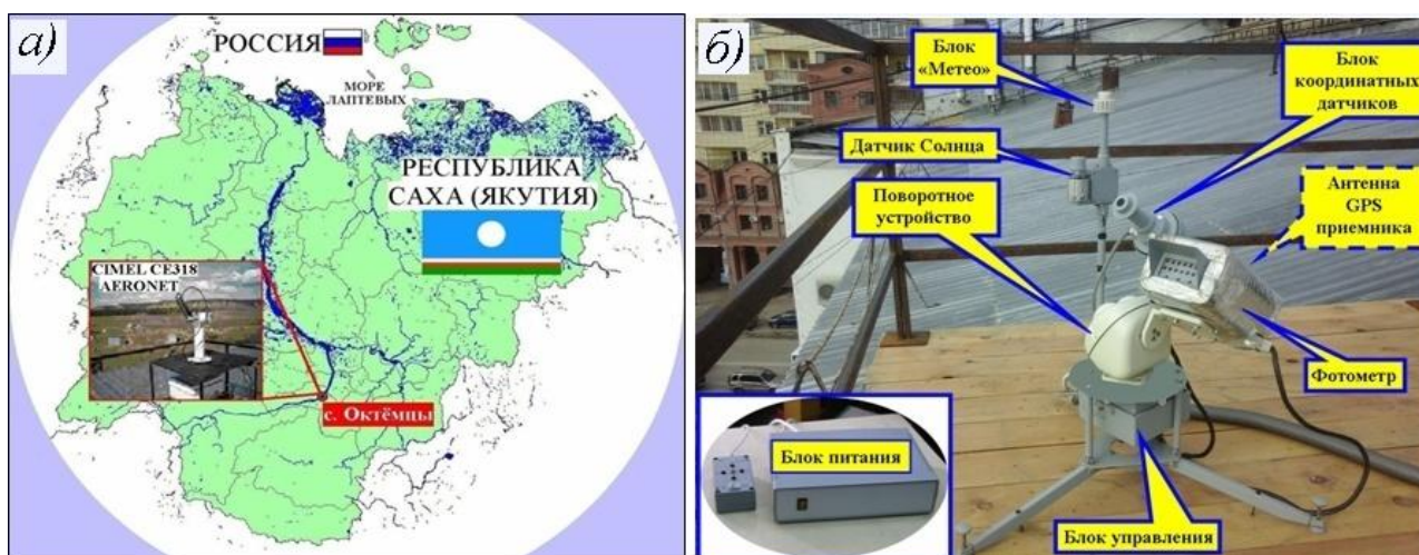
Рис. 1 (а, б) – Вид и расположение солнечного фотометра марки CIMEL CE-318 на полигоне ИКФИА «ШАЛ» (а) и SP-9 на крыше здания Института в г. Якутск (б).
