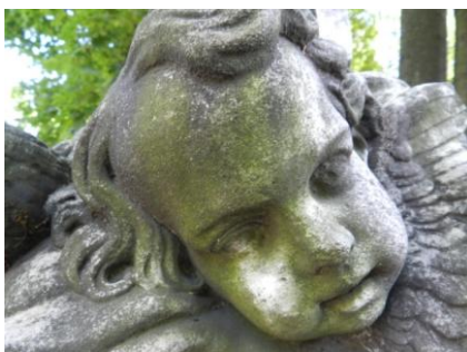
Рис. 1. Памятник в Музейном Некрополе 18 века Александро-Невской Лавры, подверженный обрастанию биопленкой с доминированием водорослей.
